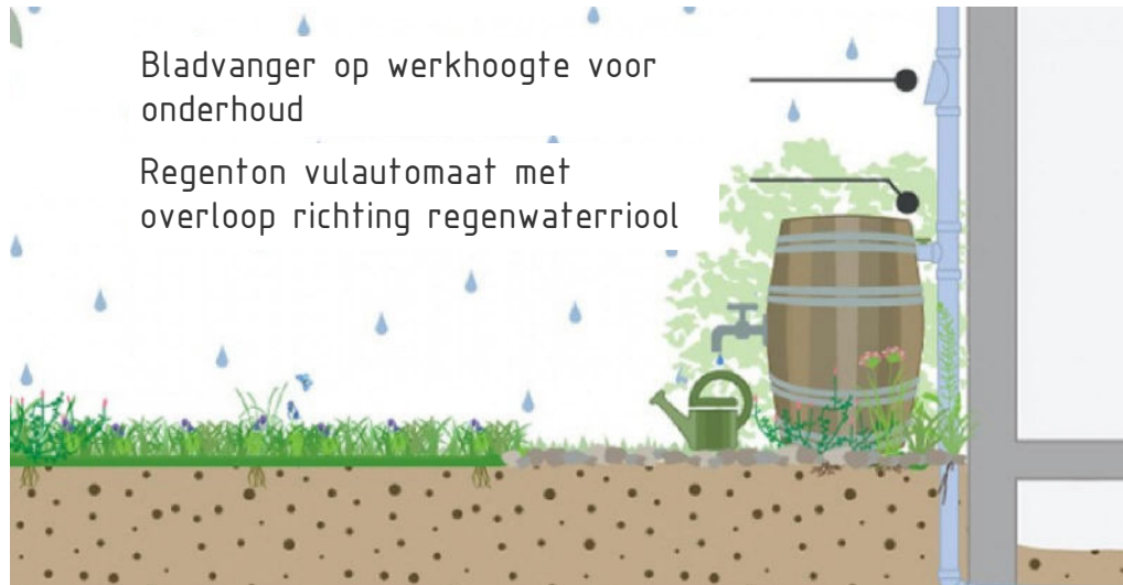
Voorbeeld afgekoppelde regenpijp met regenton
